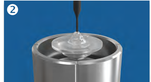
Auftrag des Einkomponenten-Klebstoffs
