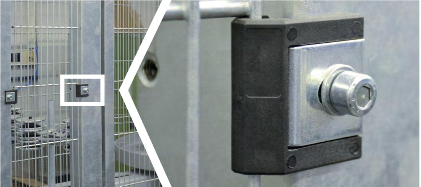
Die unbefugte Demontage von Schraubverbindungen an Maschinen und Anlagen birgt ein hohes Gefahrenpotential. Daher fordern die Berufsgenossenschaften und einschlägige Regelwerke wie die ISO 14119:2013 diverse Sicherungsmaßnahmen, um Manipulationen an Maschinen und daraus resultierende Unfälle effektiv zu verhindern.
