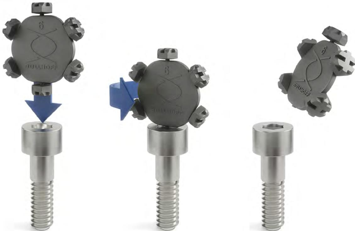
Bis zu sechs magazinierte Plugs erlauben einen werkzeuglosen und einfachen Einbau. Dafür wird der Plug mittels Handlingshilfe in den Schraubenantrieb eingesetzt und durch eine Drehung bzw. einen Kippvorgang vereinzelt. Nach dem Einsetzen bietet der PARRYPLUG® sofort einen effizienten Schutz vor unbefugten Eingriffen. Schnell und simpel: Das Einbauprinzip lässt sich ohne weitere Vorbereitungen wiederholen, bis alle Plugs verbaut sind.
