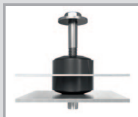
Führen der Schraube durch die Metallhülse des SITEC® Clips und verschrauben mit einer Schweiß-/Blindnietmutter an der Rückseite des Aufnahmebauteiles
